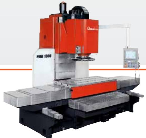
Fresatura della faccia superiore e inferiore con la fresatrice piana verticale
