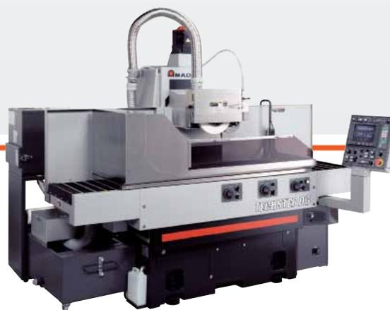
Le facce superiore ed inferiore possono essere completamente finite con la rettifica con i prodotti di AMADA MACHINE TOOLS
